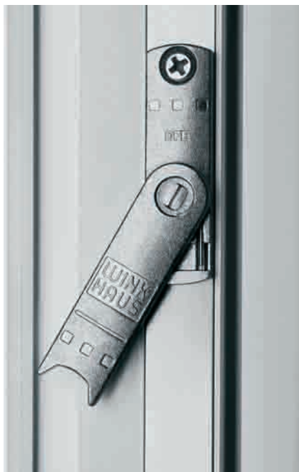
Elemento DUO- Función: El seguro de falsa maniobra evita que pueda moverse la manilla, para evitar daños tanto en la ventana como en el herraje y a su vez el elevador de hoja que se encarga del correcto posicionamiento de la hoja sobre el marco.
