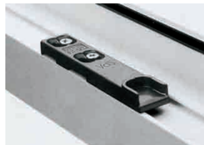
Cerraderos contactores del programa de activPilot, que transmiten la señal de abierto o cerrado a centrales de calefacción, seguridad etc.
