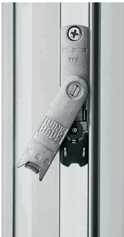
Elemento TRI- Función con seguro de falsa maniobra, elevador de hoja y clip de retención que mantiene la hoja ajustada al marco sin necesidad de cerrar.
